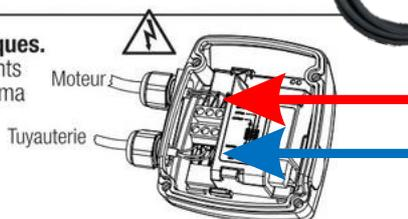
**Attention!** La protection IP 65 des pièces sous tension n'est garantie que si les chemins de câble et le volet de la carte sont bien assemblés et fixés
